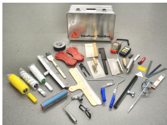
Sikafloor®-ToolBox; Sika työkalulaatikko sisältää yleisimmät työkalut sekä mittalaitteet: Art no.: 442680
