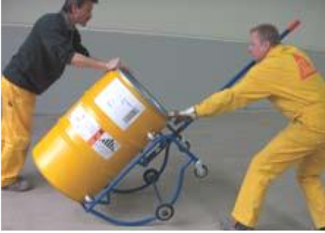
200 kg tynnyriä voidaan käsitellä helposti "tynnyrikärryillä"
