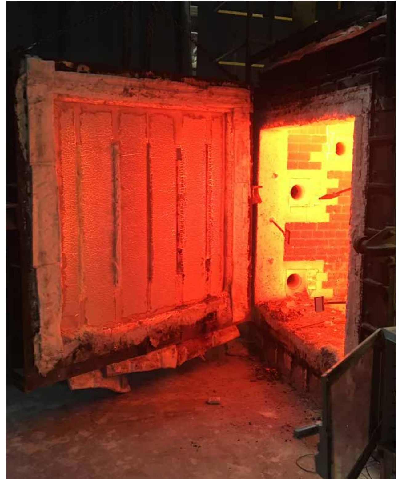
Tulipesä ja pystysuorat lineaariset saumat standardin EN 1366-4 mukaisen palonkestävyytestin jälkeen
