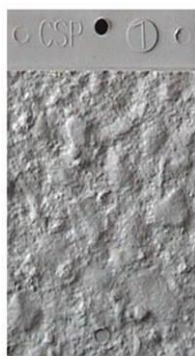
CSP-7: Raskas sinkopuhallus
